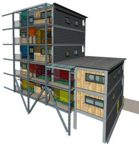
Rys. 3.1 Zastosowanie głównej konstrukcji stalowej jako podpory modułów i kasetowych stropowych.
