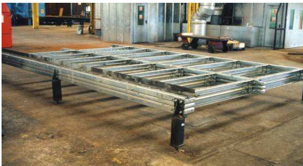
Rys. 3.1 Typowe łóże montażowe do wytwarzania paneli
